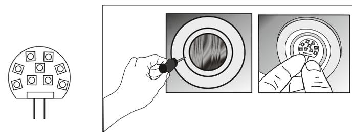
Den inneren Edelstahlring mit dem Glas mit einem kleinen Schraubenzieher leicht heraus hebeln und abnehmen. Die defekte Steck-LED-Leuchte herausziehen.
